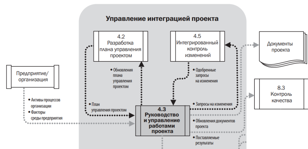
Рис. 2. Диаграмма потоков данных руководства и управления работами проекта [1]
