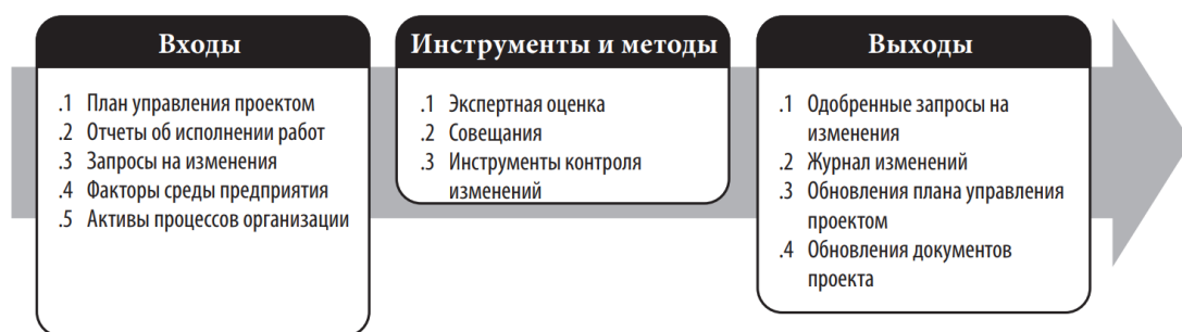
Рис. 4. Интегрированный контроль изменений: входы, инструменты и методы, выходы [1]
